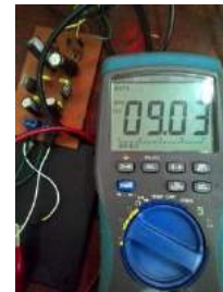
Gambar 2 Hasil Pengukuran Catu Daya 9 V
